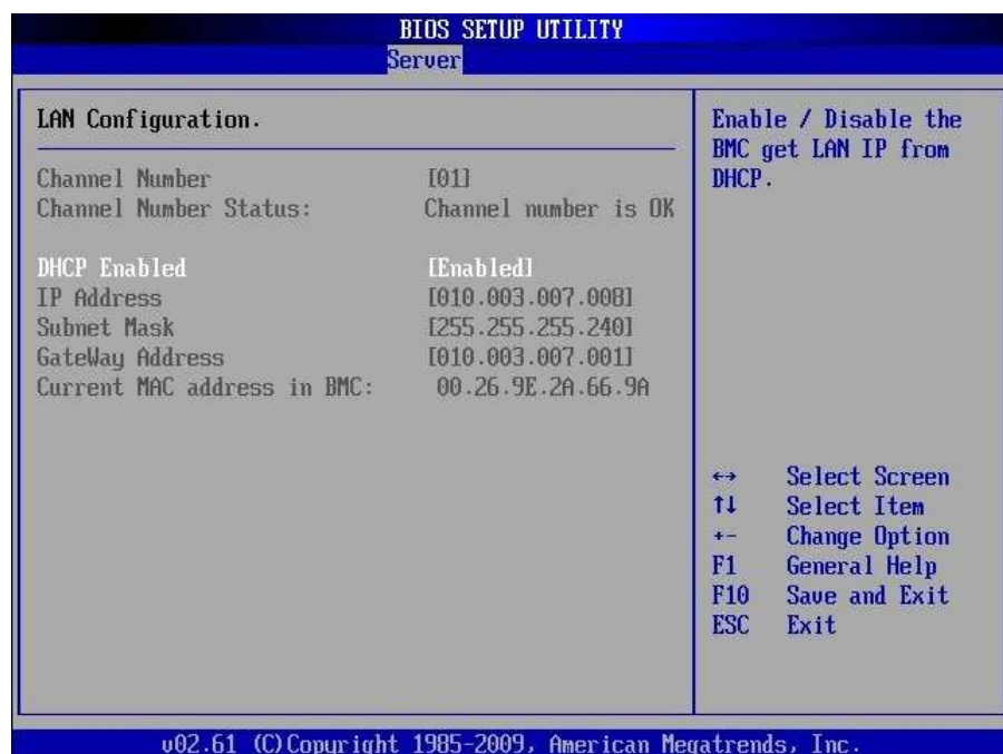
Рис. 2 : настройка IP – адреса BMC сервера.
